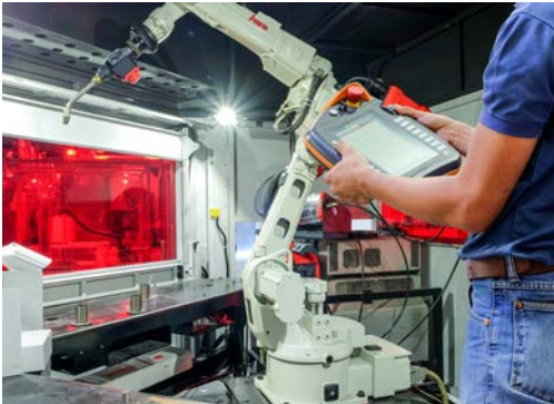
Mit 5G drahtlos gesteuerter Schweißroboter.
