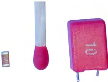
**Vergleich von Technologien bei Elektronikbauteilen:** Links ein Kondensator aus dem mobilen Gerät in SMD-Technik. Rechts ein Kondensator mit denselben elektronischen Kennwerten in THT-Technik. Die Miniaturisierung der Bauteile ist ein schon lange anhaltender Trend in der Elektronikindustrie. Der Bauteil links ist übrigens noch ein Riese unter den SMD-Bauteilen. Den Bauteil gibt es mit denselben Werten auch in einer Größe von nur 0,4mm x 0,2mm. Mit freiem Auge sieht er wie ein Staubkorn aus.
