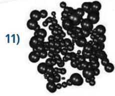
*Elementarzellen der im Harmonisierer enthaltenen Kristalle bzw. Kristallgefüge (1-9) sowie Visualisierung der amorphen Festkörper (10-11). Unterschiedlich gefärbte Atome entsprechen unterschiedlichen chemischen Elementen. Bei den beiden amorphen Festkörpern ist wegen der fehlenden Symmetrie keine Elementarzelle vorhanden.*
