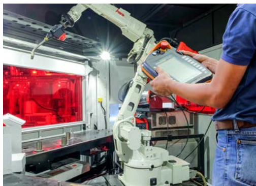
Mit 5G drahtlos gesteuerter Schweißroboter.
